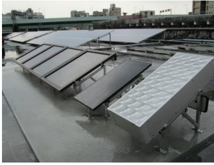
圖五：不同透光率及材質的太陽能板
